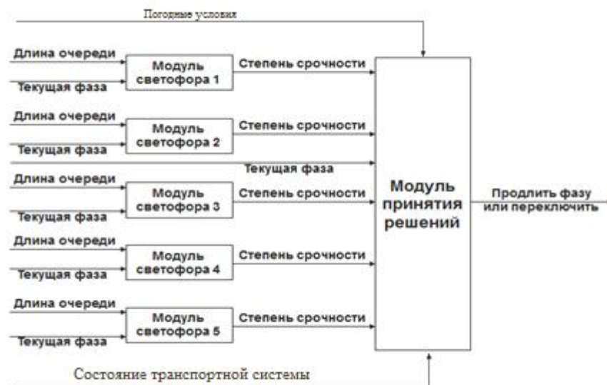
Рис. 1 – Схема работы нечеткого светофора
