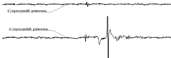
Рис. 2 – Фрагмент дефектограми для двох ниток колії
